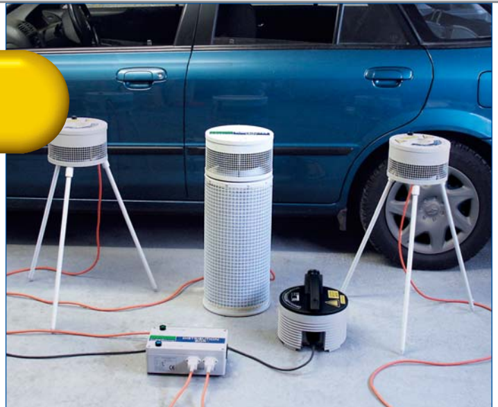
El método de fumigación permite el procesamiento completo del interior y exterior de un vehículo.
