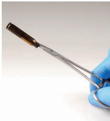
Imagen visible de 2 marcas dactilares capturadas en la vaina de un cartucho utilizando el Examinador de Superficies Cilíndricas
