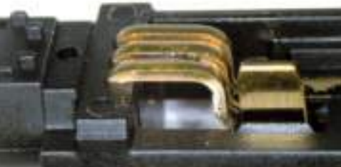
Inspección de conexiones de enchufe en la pieza moldeada por inyección
