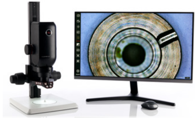
Microscopio digital Emspira 3 operado con la visualización en pantalla (OSD) de la plataforma de software Enersight.
