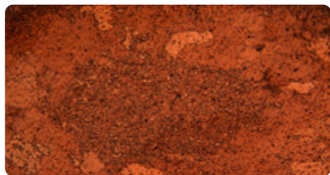
Observación de la microestructura de un cable de cobre del estátor.
