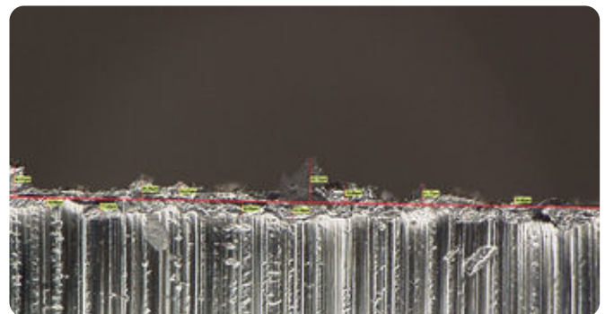
Análisis de rebabas en un borde de electrodo de batería.
