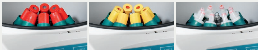
Rotor angular representado con diferentes recipientes de extracción de sangre
