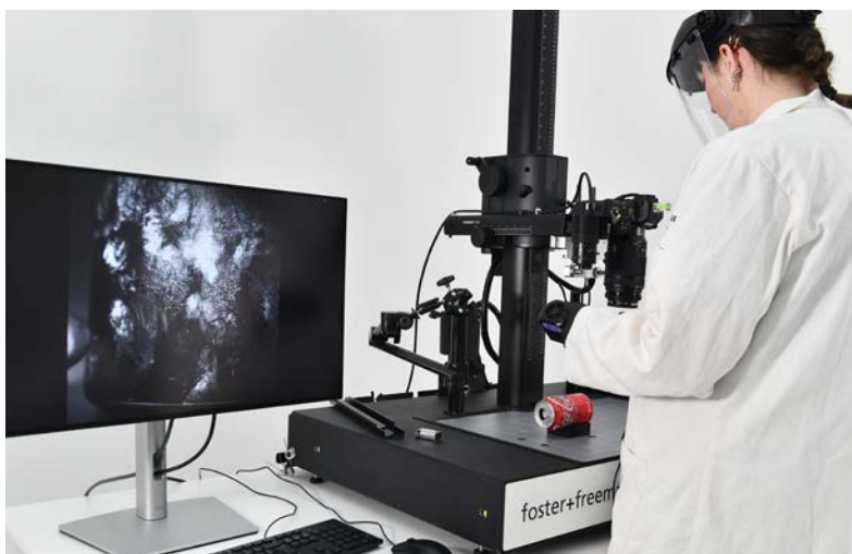
DCS 6 RUVIS: USO DE RUVIS PARA REVELAR HUELLAS DACTILARES EN ENVASES Y POLÍMEROS, MÍNIMAMENTE TRATADOS CON CIANOCRILATO
