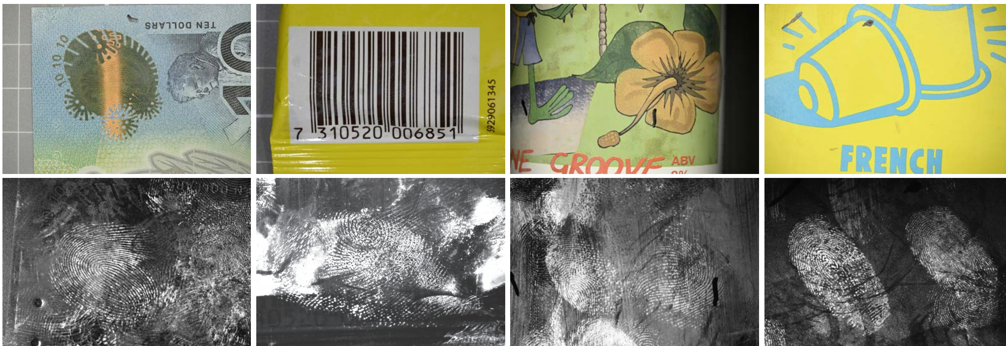
DCS 6 RUVIS: USO DE RUVIS PARA REVELAR HUELLAS DACTILARES EN ENVASES Y POLÍMEROS, MÍNIMAMENTE TRATADOS CON CIANOCRILATO
